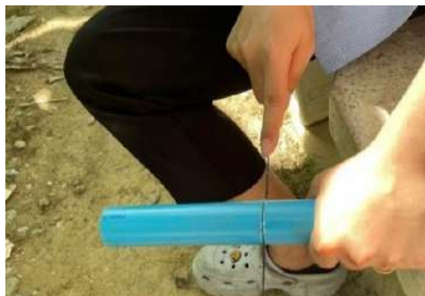
ภาพประกอบที่ 30 ตัดท่อ PVC ให้ได้ ขนาด 13 เซนติเมตร
