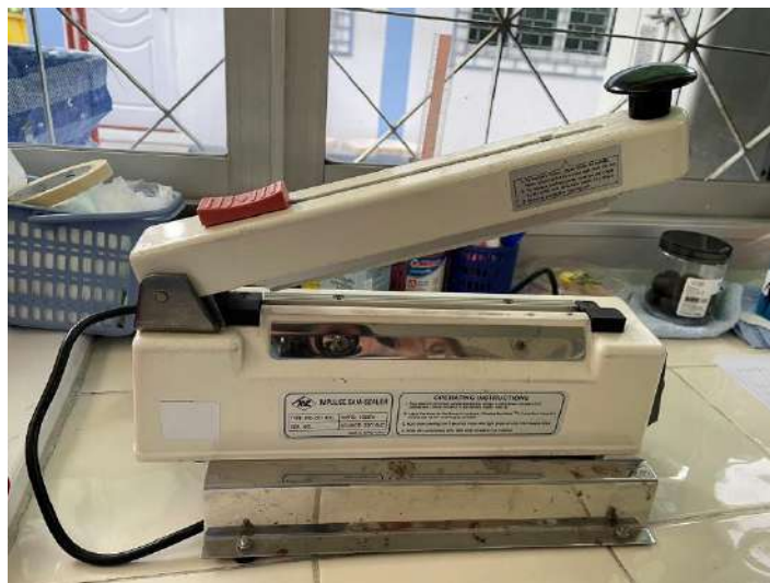
ภาพประกอบที่ 22 เครื่องซีลซองสเตอไรต์ อยู่ในห้องเตรียมอุปกรณ์ ใช้สำหรับซีลซองสเตอไรต์ที่ใส่เครื่องมืออุปกรณ์ทางการแพทย์ที่ผ่านการฆ่าเชื้อมาแล้ว
