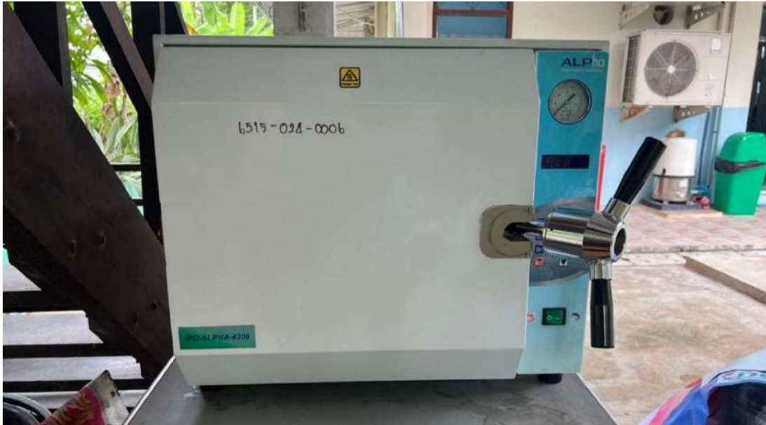
ภาพประกอบที่ 33 เครื่องนึ่งฆ่าเชื้อ (Autoclaves)
