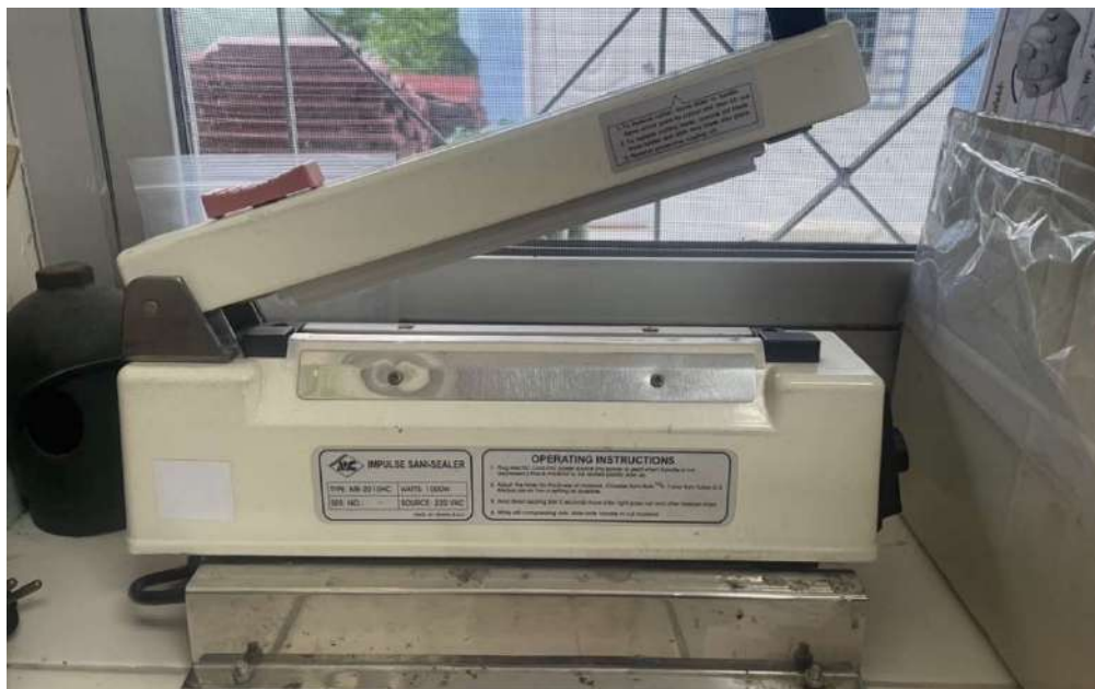
ภาพประกอบที่ 32 เครื่องซีลซองสเตอร์ไรด์
