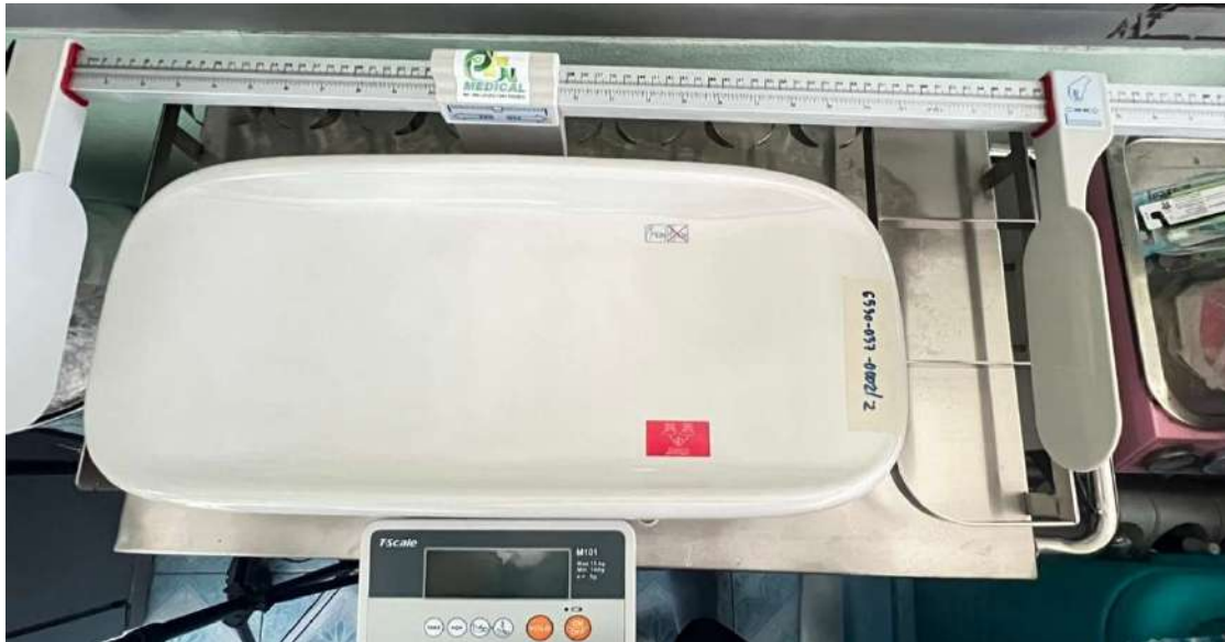
ภาพประกอบที่ 17 เครื่องชั่งน้ำหนัก และวัดส่วนสูงสำหรับเด็กทารก ใช้สำหรับชั่งน้ำหนัก และวัดส่วนสูงสำหรับเด็กทารกแรกเกิด ถึง 2 ขวบ เพื่อตรวจประเมินร่างกาย และพัฒนาการของเด็กทารกเบื้องต้น
