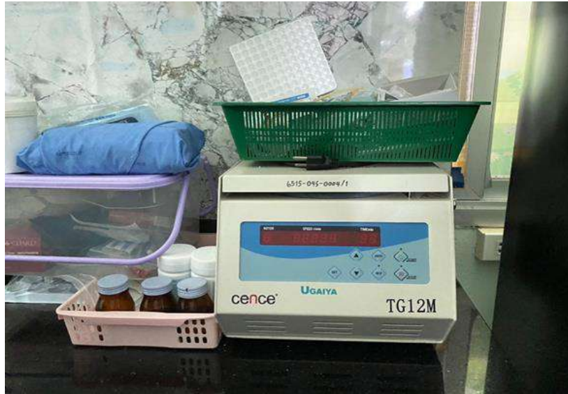
ภาพประกอบที่ 11 เครื่องหมุนเหวี่ยงปรับสมดุล ตั้งอยู่ในห้องจัดยา ใช้สำหรับแยกสารตกตะกอน หรือเลือด
